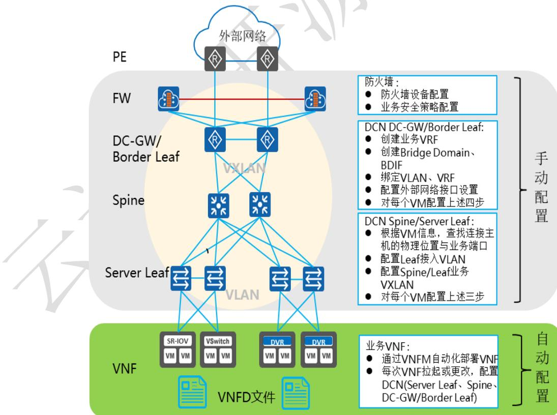
图 8 电信云网络自动配置
