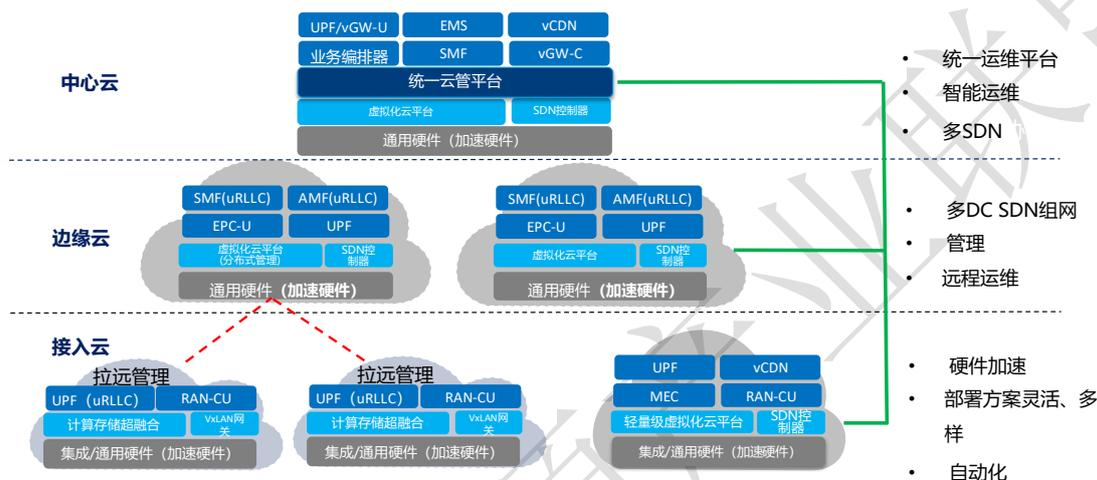
图 17 中兴通讯分布式云架构
