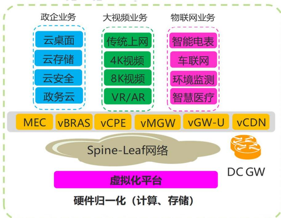
图 3 电信云部署在边缘 DC
