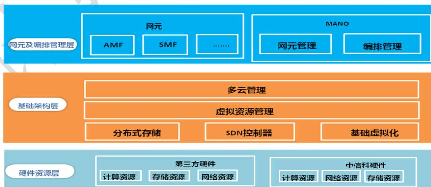
图 16 烽火 NFV 三层解耦架构
