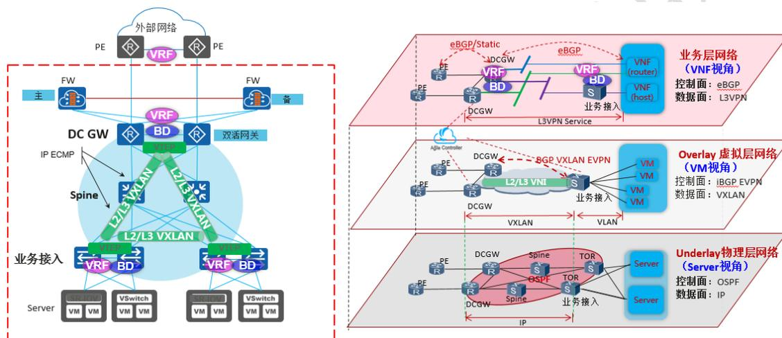
图 9 电信云三层网络架构
