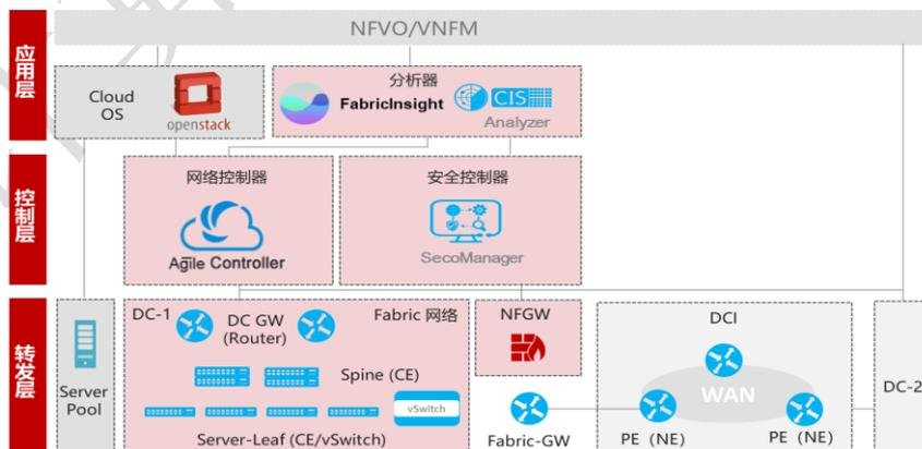
图 14 华为电信云承载网解决方案架构图
