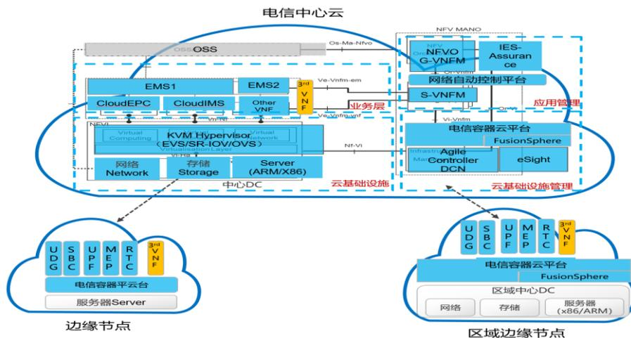
图 13 华为电信云解决方案架构图
