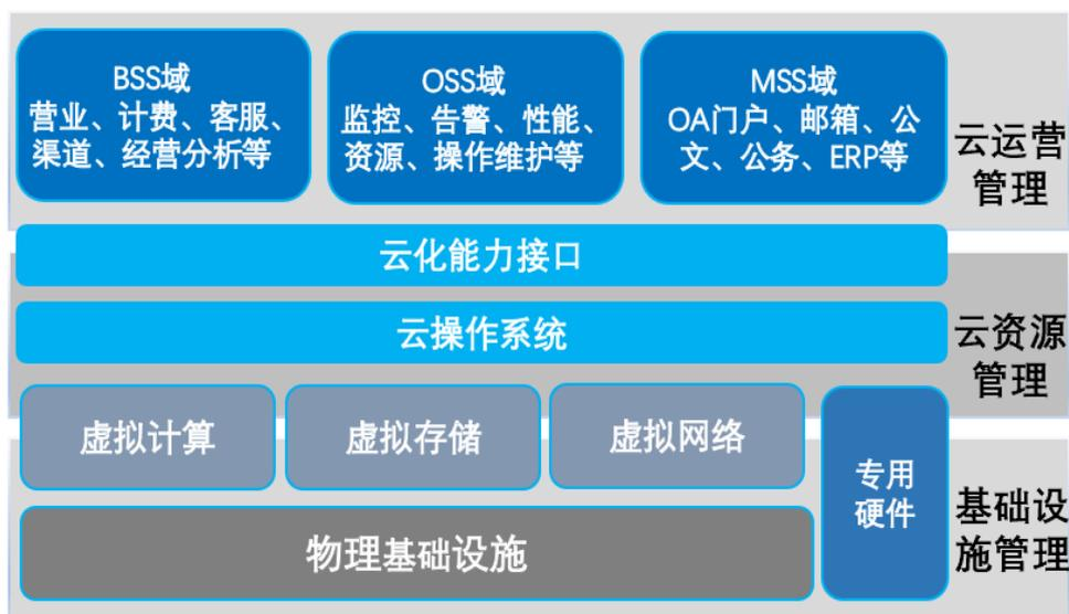
图 5 面向 IT 的电信云基础架构
