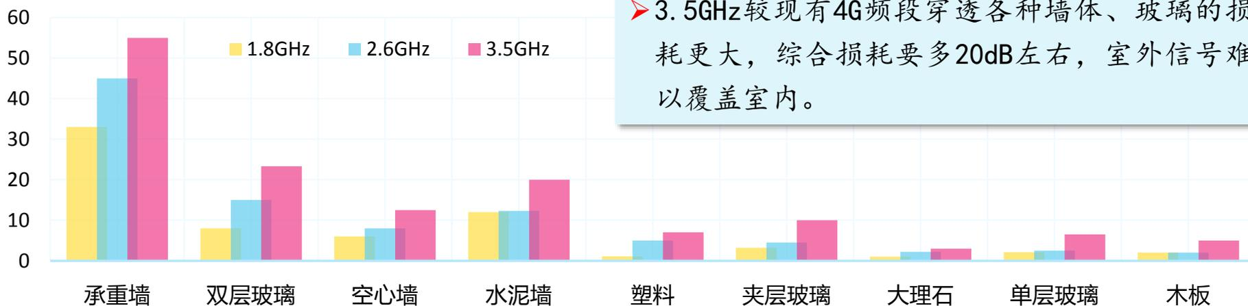
➤ 3. 5GHz较现有4G频段穿透各种墙体、玻璃的损耗更大，综合损耗要多20dB左右，室外信号难以覆盖室内。
