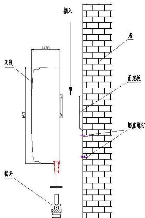
1. 用膨胀螺钉将固定板安装到墙上；
