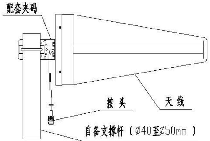
安装说明：天线安装时，应将出水孔的一侧面朝下，以防雨水进入天线罩内。
